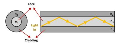
$core\ refractive\ index\ (n_1) > cladding\ refractive\ index\ (n_2)$
